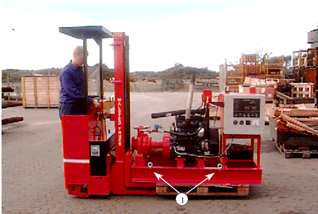
Figur 1: Transport af sprinkleranlæg, 1) Løfteøjer
