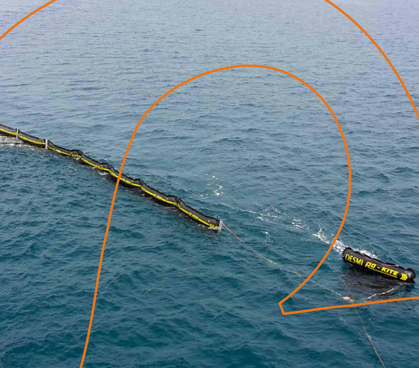
Dipositivo Flotante que elimina la necesidad de una segunda embarcación de remolque
