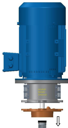
4. Ta bort axeltätningen (22) och bakre kåpan (4)
