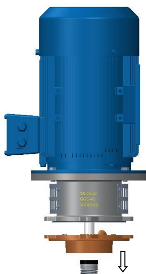
4. Wymontować uszczelnienie wału (22) i tylną pokrywę (4).
