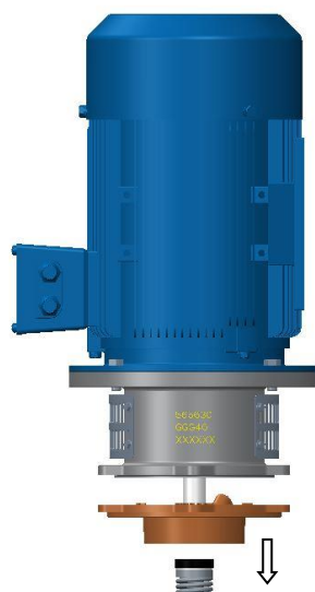
4. Fjern akseltætning (22) og bådæksel (4)
