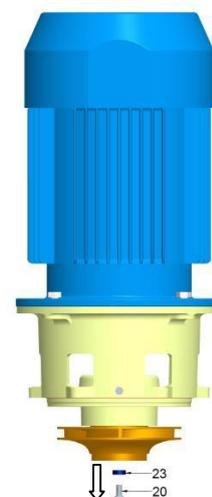
2. Снимите винт (20) и
