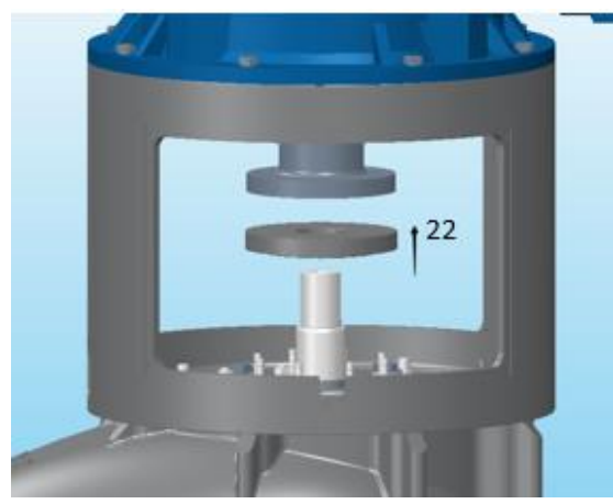
Avlägsna tätninglocket (22) från tätningssäte
