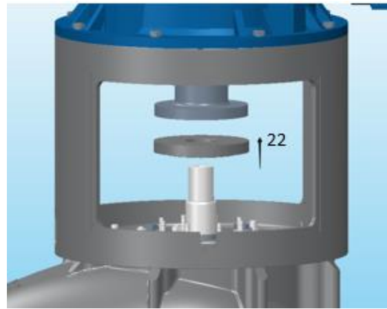
拆除机封盖及机封静环座（22）
