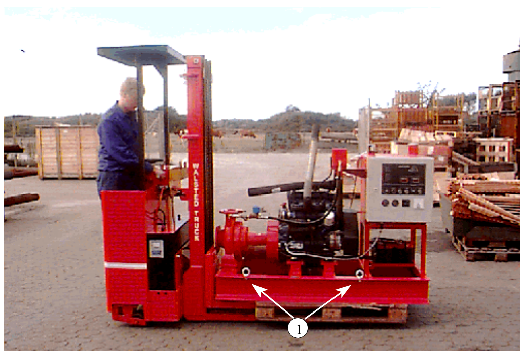
Figur 1: Transport af sprinkleranlæg, 1) Løfteøjer
