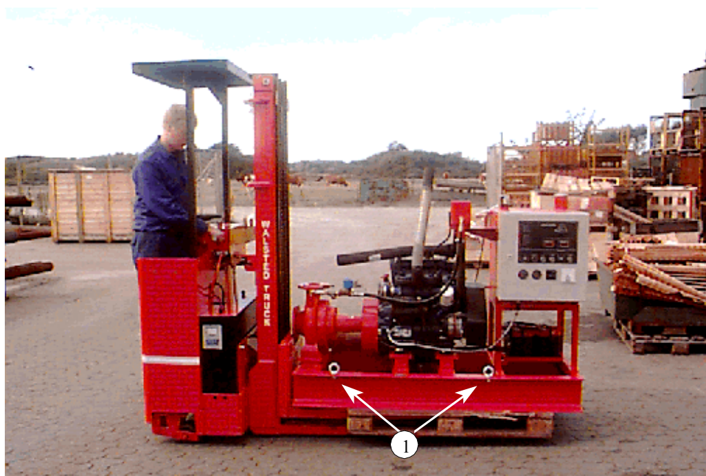
Figur 1: Transport af sprinkleranlæg, 1) Løfteøjer
